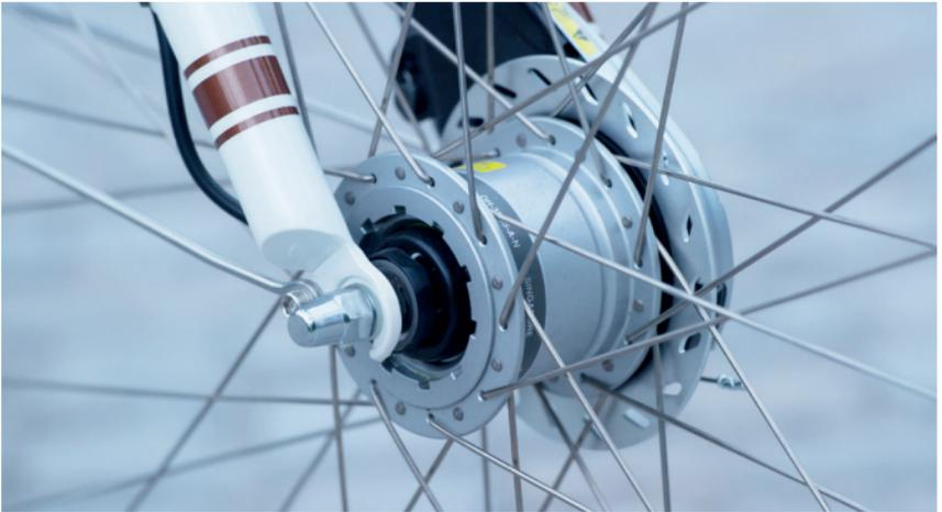
**Nabendynamos** sind zuverlässiger und wartungsärmer als die klassischen Seitenläufer. Da Nabendynamos permanent mitlaufen, eignen sie sich ideal für ein Fahren mit Tagfahrlicht. Die geforderten 10 Lux Minimalleistung können i.d.R. nur mit LED-Scheinwerfern erreicht werden. Scheinwerfer mit Glühbirnen erreichen bis zu 4 Lux, Halogenstrahler bis zu 7 Lux. Eine Nachrüstpflicht für alte Räder gibt es aber nicht.
