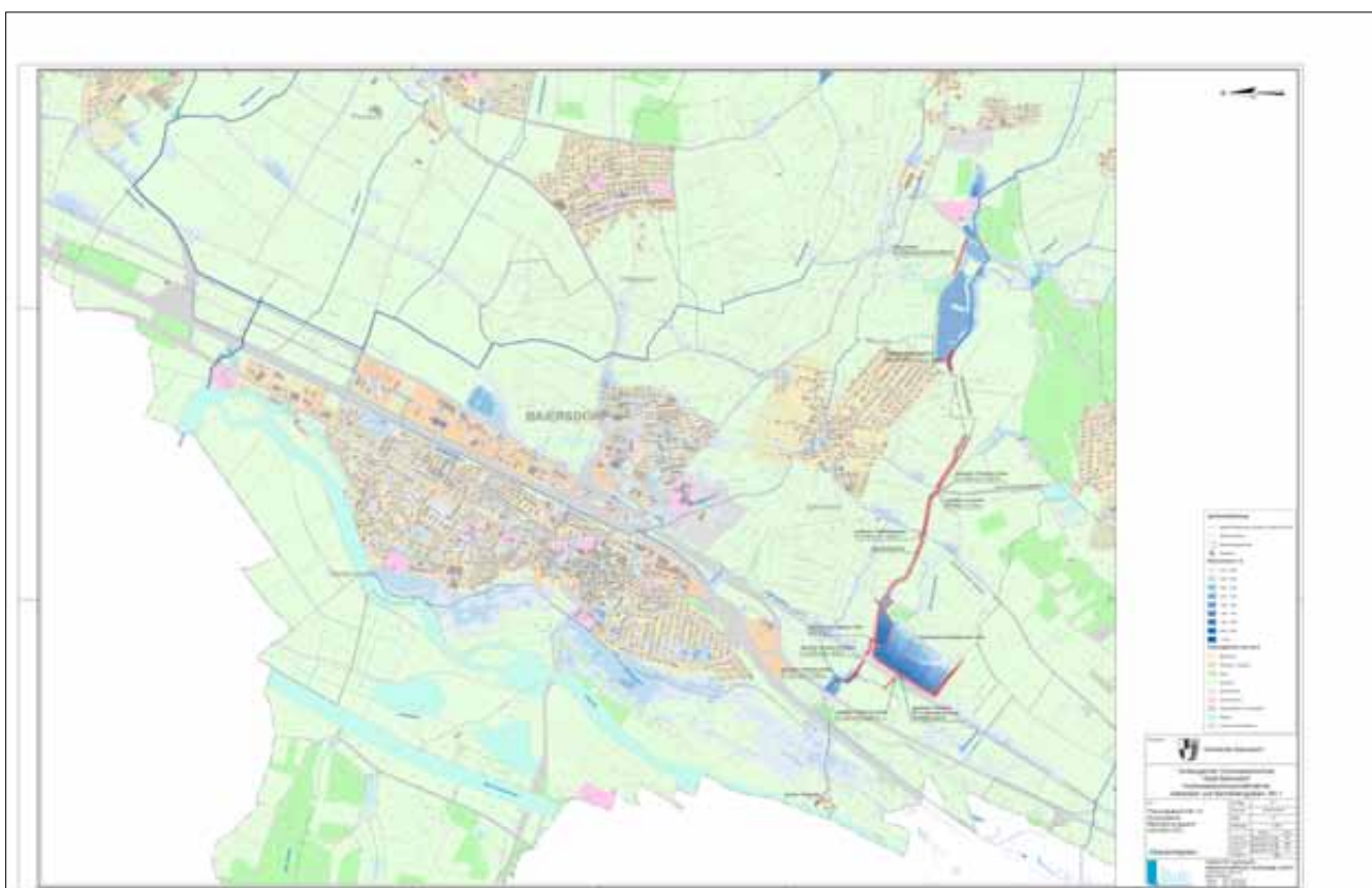
Abb. 2.42. geplante Baumaßnahmen, Hochwasserschutz Süddableitung
